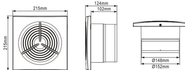
**INSTALACIÓN DEL EXTRACTOR (INSTALACIÓN EN PARED)**
