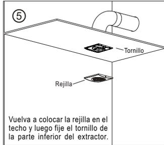
Vuelva a colocar la rejilla en el techo y luego fije el tornillo de la parte inferior del extractor.
