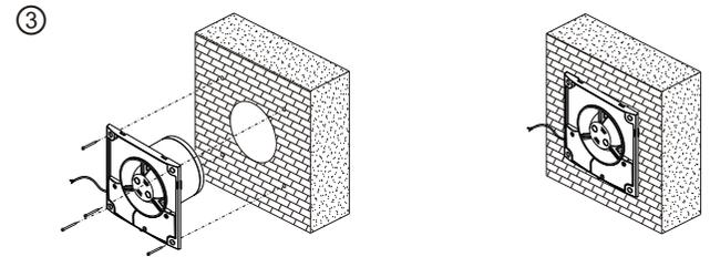
Introducir el cuerpo del extractor en el agujero de la pared y fijar los 4 tornillos que se incluyen con el producto.
