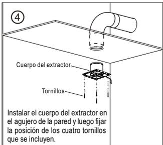
Instalar el cuerpo del extractor en el agujero de la pared y luego fijar la posición de los cuatro tornillos que se incluyen.
