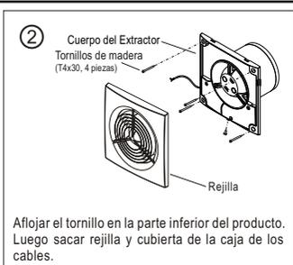
Aflojar el tornillo en la parte inferior del producto. Luego sacar rejilla y cubierta de la caja de los cables.
