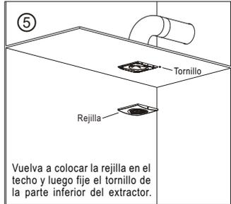
Vuelva a colocar la rejilla en el techo y luego fije el tornillo de la parte inferior del extractor.
